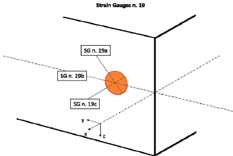
Figure 38 – Position of rosette n.19 (orange element) installed on the web of the front spar.
